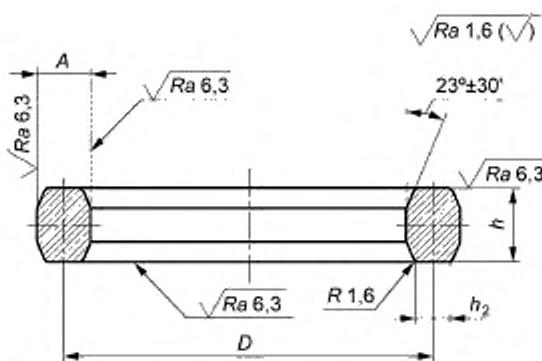
Рисунок 3 — Прокладки восьмиугольного сечения типа 2 для фланцев (см. [1])
