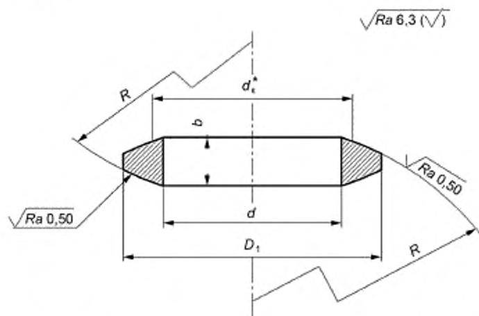
Рисунок 4 — Прокладки линзовидные типа 3 для фланцев по ГОСТ 33259
